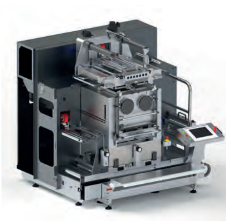
Das Prägemodul der Big Foot mit 50t Prägedruck. (Bildquelle: A B Graphic International)
